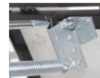
б) отверстия для крепления шарнира с резьбой (7) при вертикальном креплении форточки или двери.
